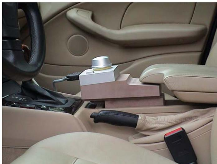
*Abbildung 5-1: Zwischen Fahrer und Beifahrersitz montierte Bedieneinheit, die im Wesentlichen aus einem Dreh-Drücksteller und einer separaten Taste für die Rücksprungfunktion besteht. Das Gehäuse kann in Längsrichtung verschoben werden.*
