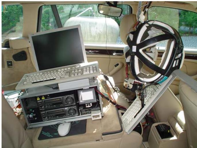
*Abbildung 5-5: Einbau der Videoaufzeichnungsgeräte des JANUS-Systems und der Steuerungsgeräte für das LfE-Cruise auf der Rückbank des Versuchsfahrzeugs. Mit dem innen eingebauten Rückspiegel kann der Versuchsbegleiter den nachfolgenden Verkehr im Auge behalten. Der JANUS-Helm ist zum Transport aufgehängt.*
