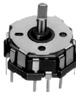
*Abbildung 5-2: Verbauter Dreh-Drücksteller (RKJXT1E12001) der Firma Alps. Dieser Controller vereint auf einem Bauraum von 16,8 mm Breite und 6,8 mm Höhe eine Drehfunktion mit einer  $12^\circ$  Rasterung, eine Drückfunktion und eine Kippfunktion in acht Richtungen.*
