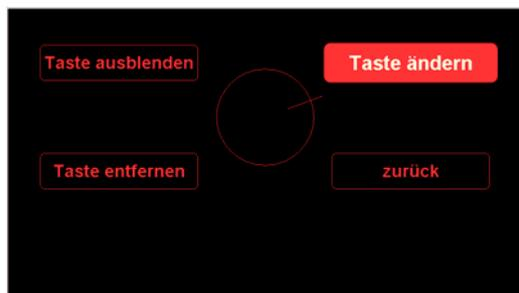
*Abbildung 4-1: Beispiel für die graphische Gestaltung einer Menüebene. In der Mitte symbolisiert ein Kreis den Dreh-Drücksteller. Der angewählte Menüpunkt ist hervorgehoben. Aus jeder Ebene kann über das „zurück“-Feld die nächsthöhere Ebene erreicht werden.*
