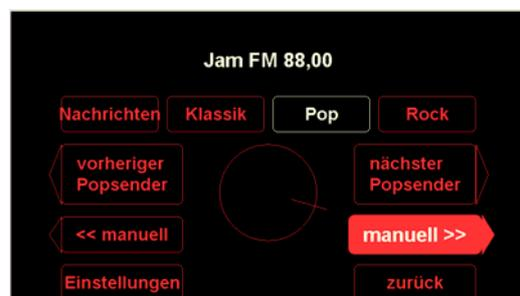
*Abbildung 4-16: Basisoberfläche der Radioaufgabe. Das Radio kann Radiosender anhand des Inhalts klassifizieren und ermöglicht damit eine gezieltere Sendersuche. Selbstverständlich kann ein Sender auch über die „manuell“-Tasten gefunden werden.*
