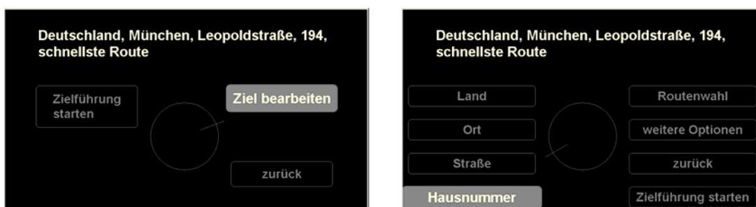
Abbildung 4-15: Schlüsselposition innerhalb der Navigationsaufgabe, bei der die schlechte Lösung (links) vom systemergonomischen Soll abweicht. Die gute Variante (rechts) bietet dem Anwender alle notwendigen Auswahlmöglichkeiten simultan an.
