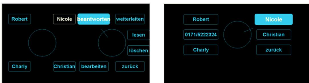
Abbildung 4-9: Gegenüberstellung der Auswahlebene für empfangene SMS-Nachrichten. Links ist die schlechte Variante abgebildet, bei der zwei sequentielle Schritte simultan dargestellt werden. Bei der rechten guten Version muss sich der Anwender nur auf die erhaltenen Nachrichten konzentrieren.
